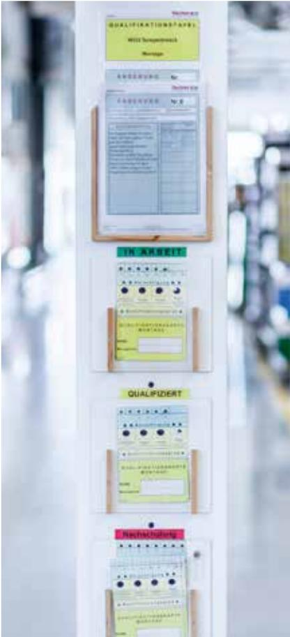
**Bild 2.** Qualifikationstafel: Bei diesem rollierenden Informationssystem werden Informationen schichtübergreifend auf einem Formular eingetragen und mit Bildern beschrieben. Die Lochreihe auf der Mitarbeiterkarte zeigt seine Berechtigungsstufen. Die Qualifizierungsstufen sind darunter abgebildet
