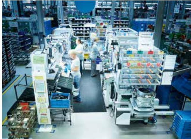
**Bild 1.** Montage in U-Form: Diese Anordnung ist dem Arbeitsfluss angepasst und erleichtert sowohl die Kommunikation als auch die Mehrmaschinenbedienung
